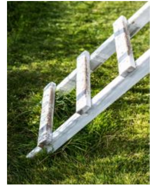
Sprossenbreite \geq 20\text{mm} b < 80\text{mm}
